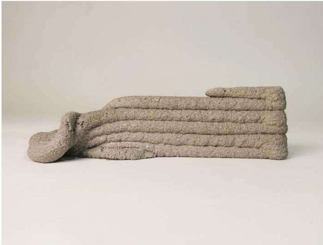
Amostra impressa em betão usando uma altura de camada de 10 mm
