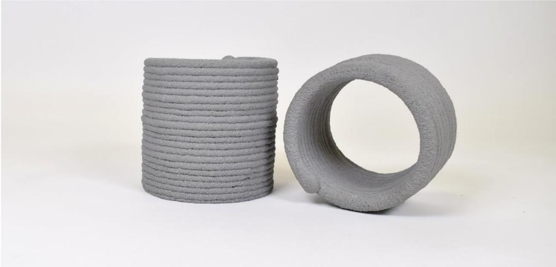
*Figura 7. Fabricação Aditiva em Betão: Exemplo de 2 provetes cilíndricos impressos camada a camada.*
