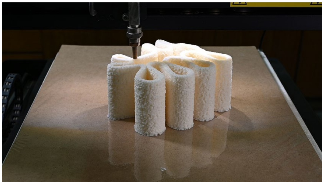
Tatiana Vilaça Campos (fotografia, 202x). "Impressão de um bloco acústico tirando partido das técnicas de fabricação aditiva e a utilização de materiais de origem natural, a celulose".
